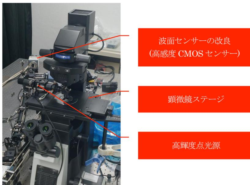
図 8 補償光学顕微鏡における分子揺動観察実験系 (基礎生物学研究所)
