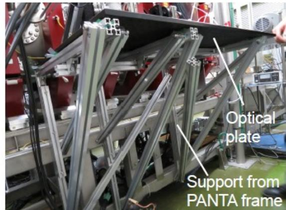
図 3(a) 平成 27 年度における入射光学系。光学プレートを真空フランジから支持している。(b) 平成 28 年度に設置した新しい入射光学系架台。PANTA の架台に支持構造を固定し、広い光学プレート(60×90 cm)を設置して、光学系設計の自由度を上げている。
